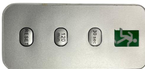
2. Der erste automatische Test wird 24 Stunden nach dem Anschluss durchgeführt. Anschließend werden die Funktionen der Notlichtleuchte alle 4 Wochen getestet und die Batterielaufzeit wird jährlich geprüft. Jede Leuchte mit Autotestfunktion enthält eine zweifarbige LED, die immer sichtbar ist. Bei grünem Licht arbeitet die Leuchte einwandfrei. Bei rotem Licht besteht Handlungsbedarf.
